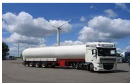
Rys. 17. Specjalistyczny środek transportu - do przewozu materiałów sypkich
