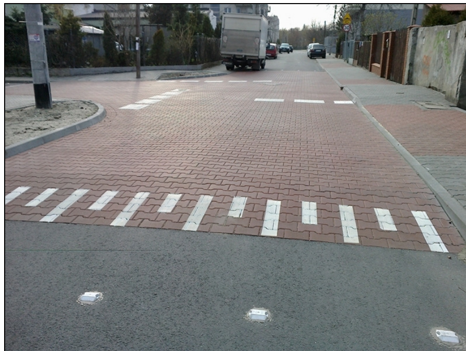
Rysunek nr 8. Przykład wyniesionego skrzyżowania (Źródło: zm.org.pl)
