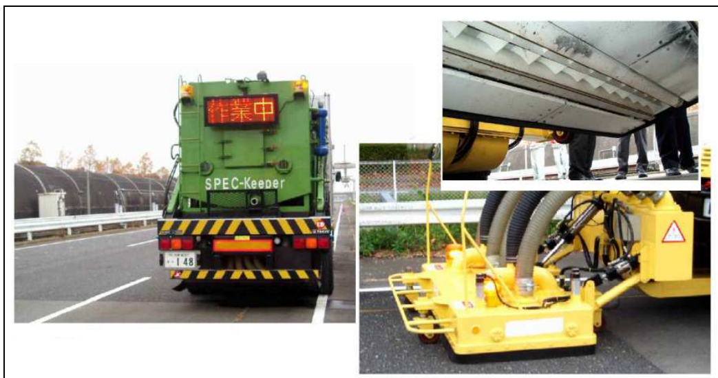
Rysunek nr 9. Sprzęt wykorzystywany przy oczyszczaniu nawierzchni z asfaltu porowatego (Źródło: Zastosowanie nowoczesnych technologii w konstrukcjach drogowych, Zakopane 15-17.09.2010 r.)
