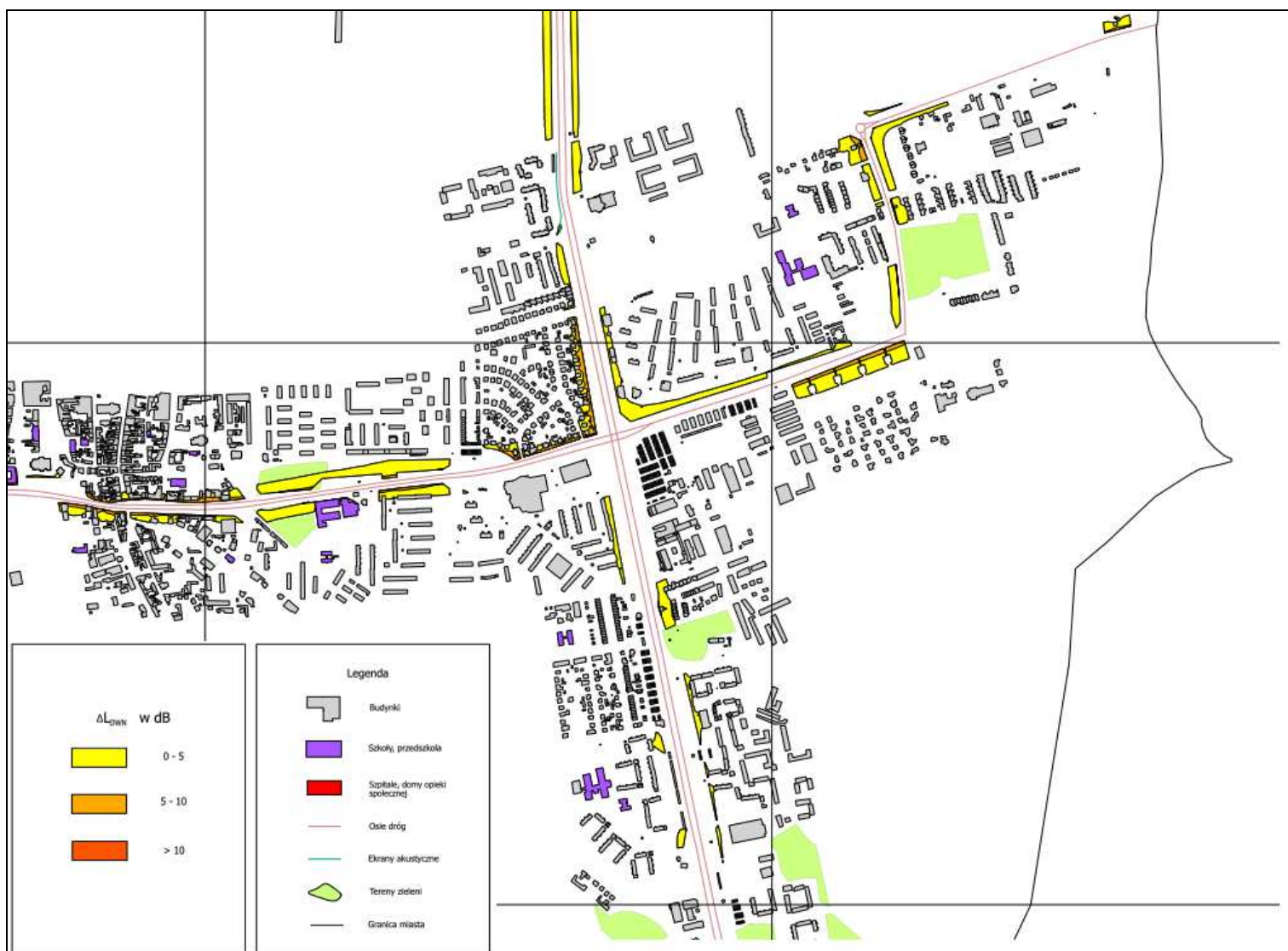
Rysunek nr 3. Fragment mapy przekroczeń poziomów dopuszczalnych hałasu pochodzenia drogowego
