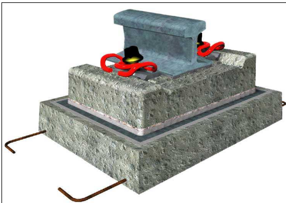
Rysunek nr 13. Przykładowy system podpór blokowych w otulinie
