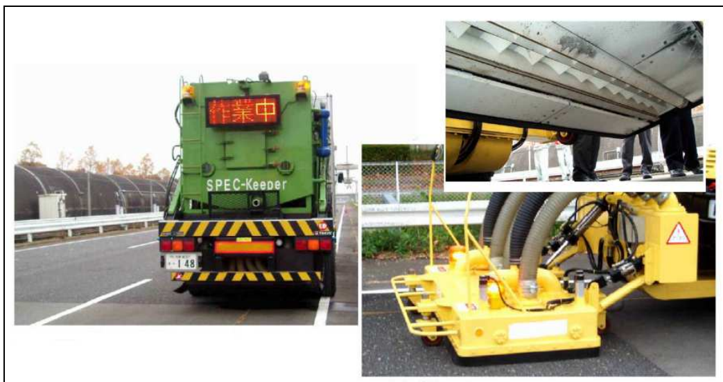
Rysunek nr 12. Sprzęt wykorzystywany przy oczyszczaniu nawierzchni z asfaltu porowatego (Źródło: Zastosowanie nowoczesnych technologii w konstrukcjach drogowych , Zakopane 15-17.09.2010 r.)
