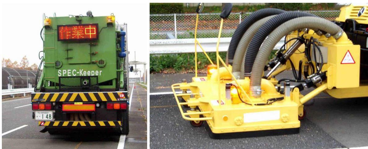
Rys. 10. Po lewej - samochód do czyszczenia cichych nawierzchni z użyciem wody; po prawej - czyszczenie nawierzchni przy wykorzystaniu sprężonego powietrza (źródło: Noise reducing pavements in Japan - study tour report, Danish Road Institute, 2005, DRI-DWW noise abatement program)
