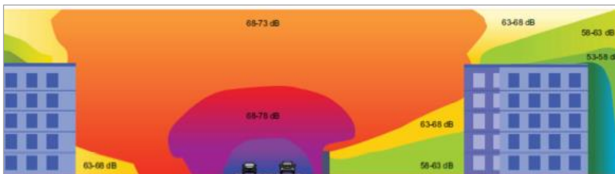
Rys. 15. Przykład propagacji hałasu drogowego (10 000 przejazdów/dzień ze średnią prędkością 50 km/h) w sąsiedztwie zabudowy o wys. 20 m - zasięg hałasu przy obecności ekranu o wys. 3 m (strona prawa) oraz bez ekranu (strona lewa) (źródło: CEDR Call 2012: Noise; ON-AIR Optimised Noise Assessment and Management Guidance for National Roads; Investigation of noise planning procedures and tools, 2015)
