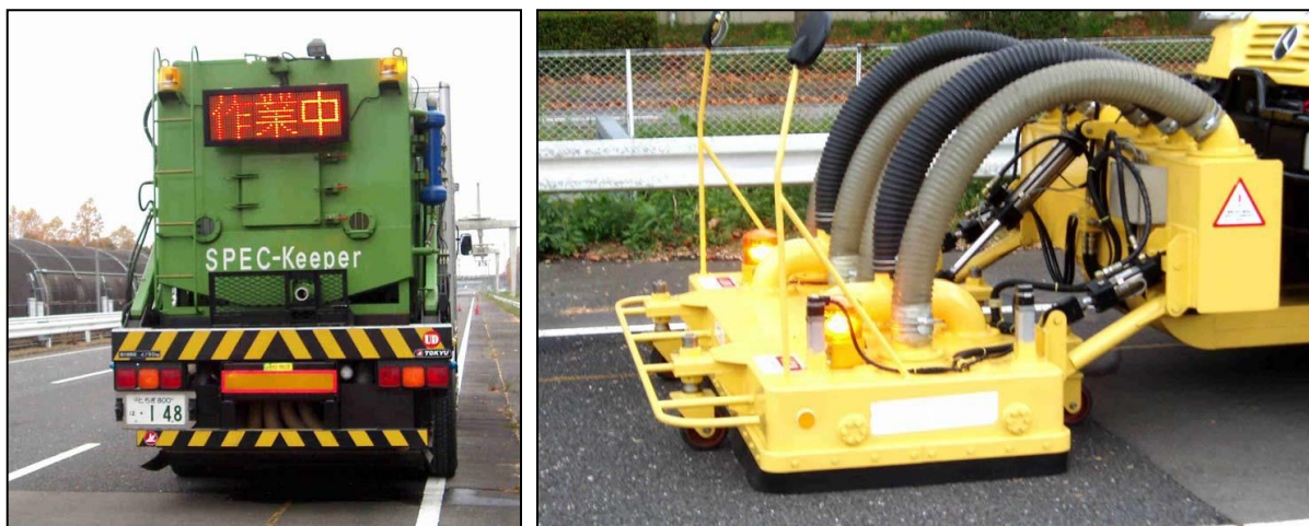
Rys. 7. Po lewej - samochód do czyszczenia cichych nawierzchni z pomocą wody; po prawej - czyszczenie nawierzchni przy wykorzystaniu sprężonego powietrza (źródło: Noise reducing pavements in Japan - study tour report, Danish Road Institute, 2005, DRI-DWW noise abatement program )
