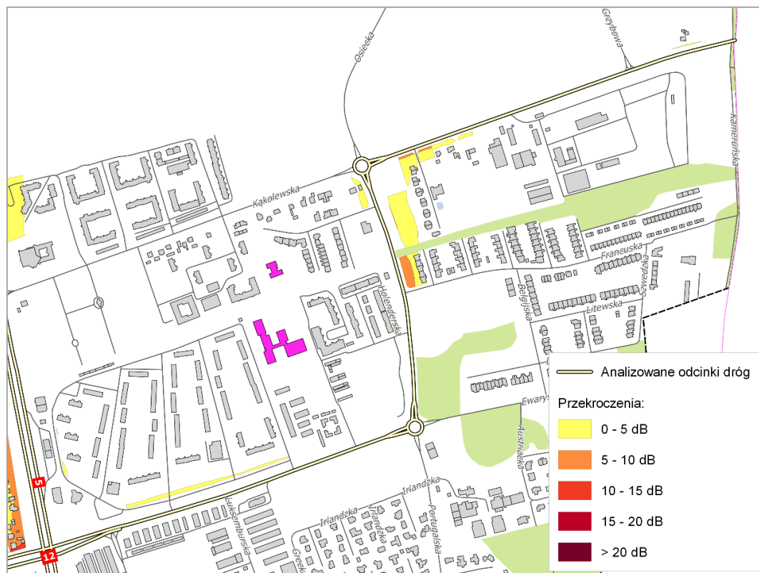
Rys. 28. Mapa przekroczeń dla wskaźnika L_{DWN} dla obszaru wokół wschodniego odcinka drogi krajowej nr 12
