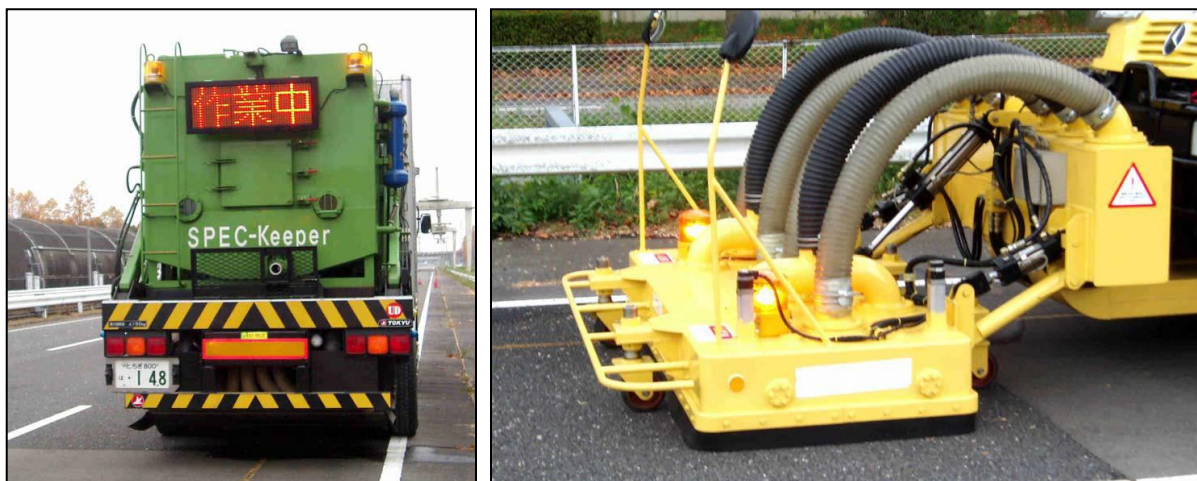
Rys. 9 Po lewej - samochód do czyszczenia cichych nawierzchni z pomocą wody; po prawej - czyszczenie nawierzchni przy wykorzystaniu sprężonego powietrza (źródło: Noise reducing pavements in Japan - study tour report, Danish Road Institute, 2005, DRI-DWW noise abatement program )
