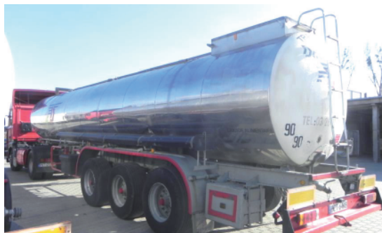
Rys. 14. Specjalistyczny środek transportu-cysterna do przewozu środków spożywczych w stanie płynnym
