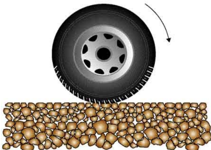
Rysunek 50. Asphalt porowaty o dużej zawartości próżni (źródło nynas.com)
