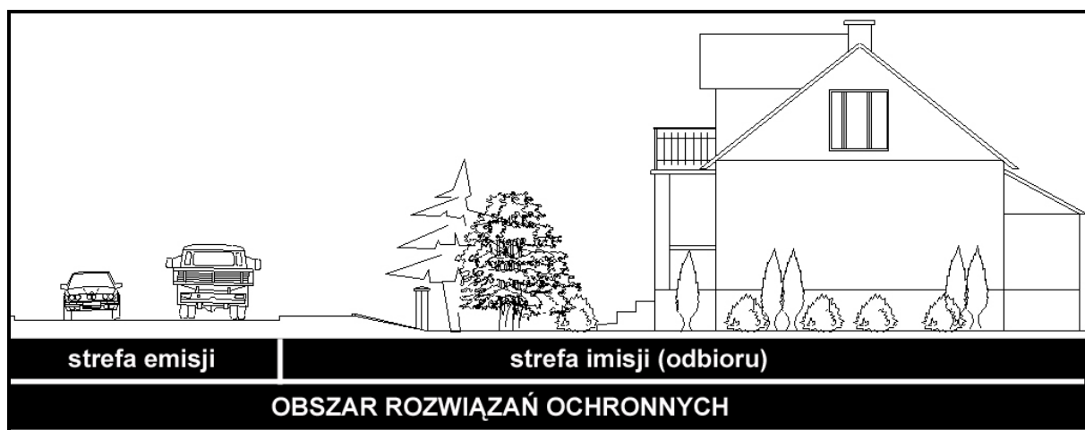
Rys. 6. Strefy emisji i imisji hałasu oraz obszar rozwiązań ochronnych w uniwersalnym podejściu do ochrony przed hałasem drogowym
