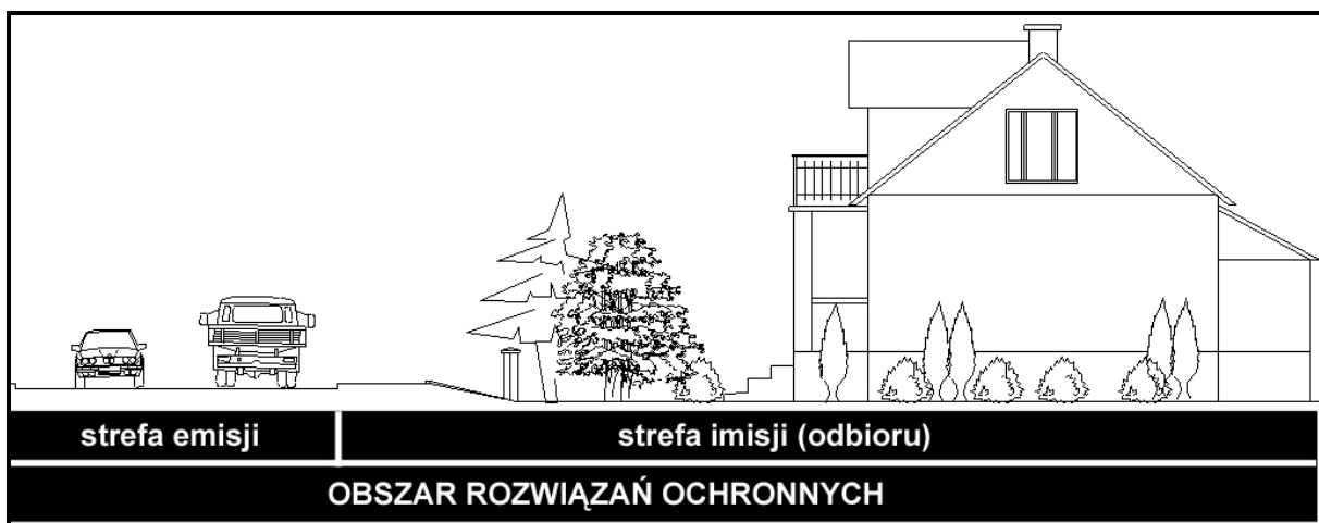
Rys. 3. Strefy emisji i imisji hałasu oraz obszar rozwiązań ochronnych w uniwersalnym podejściu do ochrony przed hałasem drogowym
