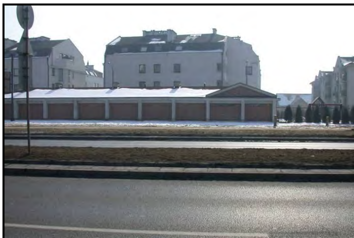
Fot. 5. Ekranowanie obiektów mieszkalnych przez garaże usytuowane bezpośrednio przy ulicy (Polska)
